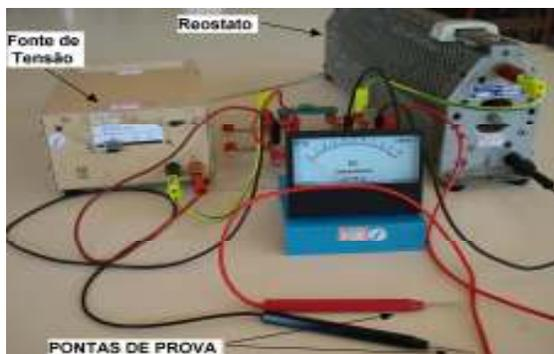
Figura 2.7 - Ohmímetro montado
