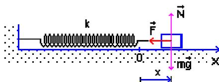
O modelo teórico para descrever oscilações que ocorrem quando um corpo de massa  $m$  está preso à extremidade de uma mola (conforme mostra a figura acima) é construído a partir da Segunda Lei de Newton. Essa lei pode ser escrita como  $F = m a$  ou  $\mathbf{F} = m (\mathbf{d}^2\mathbf{x}(t)/\mathbf{d} t^2)$  na sua forma escalar para movimentos unidimensionais, como é este caso.
