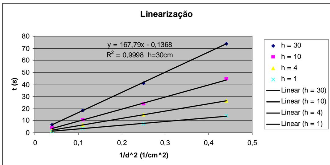
**Figura 4.** Gráfico de t versus  $1/d^2$ . O resultado sugere fortemente que o tempo de esvaziamento é diretamente proporcional a  $1/d^2$ . Neste exemplo é mostrado apenas o resultado para h= 30 cm. Complete o gráfico para todas as outras alturas.
