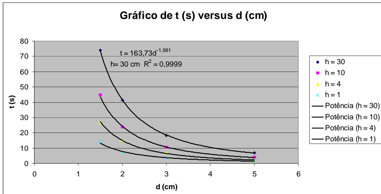
**Figura 2.** Gráfico t versus d. As curvas sugerem uma relação inversa entre t e d, isto é, sugerem que t diminuiu com d, mas não fornecem uma relação matemática entre elas.
